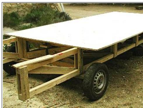
Des roues de récupération sont fixées sous un châssis en bois qui supporte une boîte en grand panneaux de « trois-plis ».
